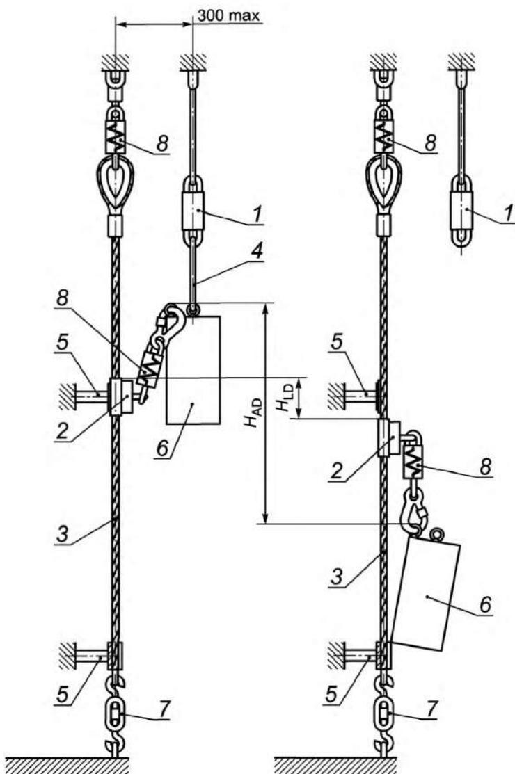
$H_{LD}$  — участок торможения;  $H_{AD}$  — страховочный участок; 1 — устройство быстрого расцепления;
