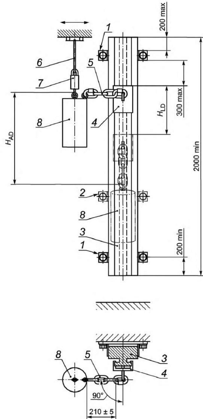
$H_{LD}$  — участок торможения;  $H_{AD}$  — страховочный участок; 1 — элемент крепления;
