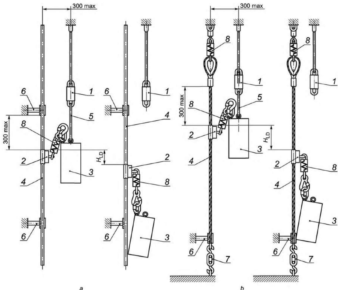
$H_{LD}$  — участок торможения; 1 — устройство быстрого расцепления; 2 — средство индивидуальной защиты ползункового типа; 3 — жесткий испытательный груз; 4 — жесткая анкерная линия; 5 — соединительный канат; 6 — элемент крепления или направляющий элемент; 7 — устройство предварительного натяжения; 8 — амортизатор (при наличии)
