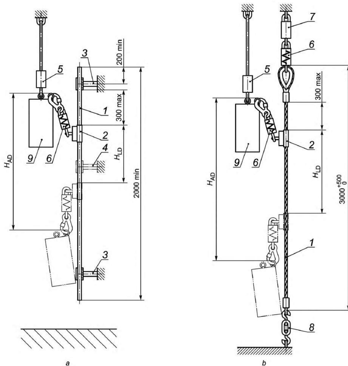
$H_{LD}$  — участок торможения; 1 — жесткая анкерная линия; 2 — средство индивидуальной защиты ползункового типа; 3 — элемент крепления; 4 — дополнительный элемент крепления (в зависимости от монтажной инструкции изготовителя); 5 — устройство быстрого расцепления; 6 — амортизатор (при наличии); 7 — тензодатчик (для проверки предварительного натяжения); 8 — устройство предварительного натяжения; 9 — жесткий испытательный груз
