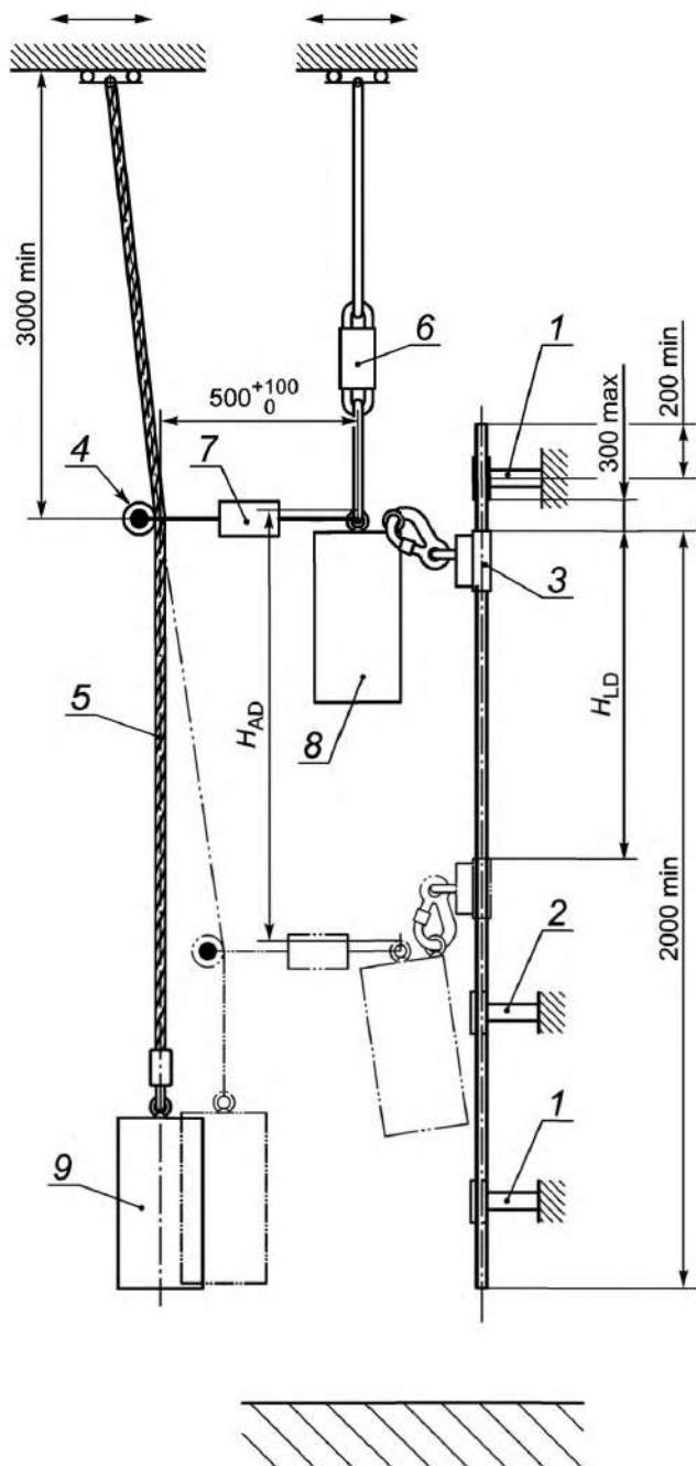
$H_{LD}$  — участок торможения;  $H_{AD}$  — страховочный участок; 1 — элемент крепления;
