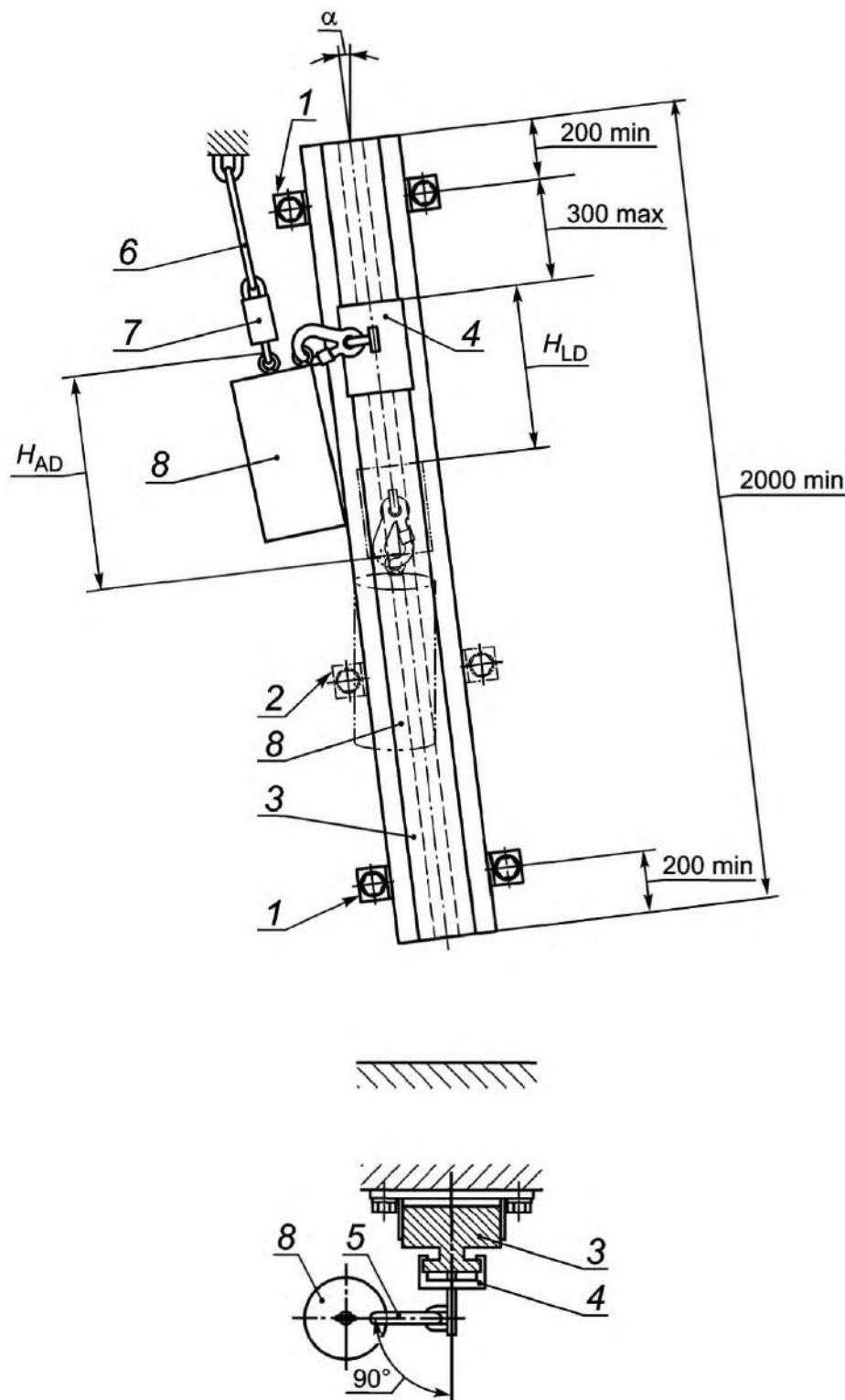
$H_{LD}$  — участок торможения;  $H_{AD}$  — страховочный участок; 1 — элемент крепления;
