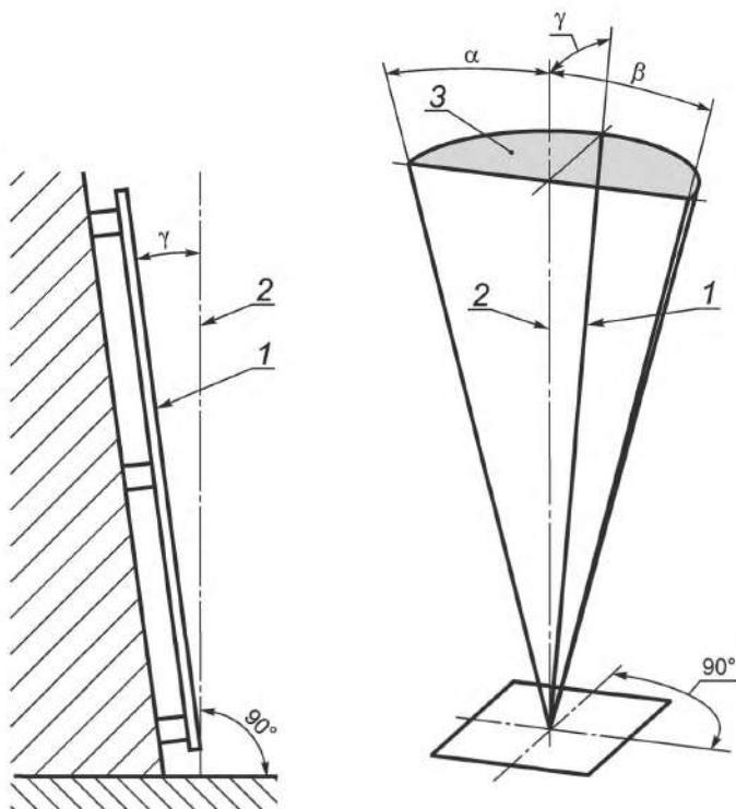
1 — жесткая анкерная линия; 2 — вертикаль; 3 — зона возможного расположения;  $\alpha$  — (альфа) левый угол с боковым отклонением  $0^\circ$ — $15^\circ$ ;  $\beta$  — (бета) правый угол с боковым отклонением  $0^\circ$ — $15^\circ$ ;  $\gamma$  — (гамма) угол с отклонением вперед  $0^\circ$ — $15^\circ$
