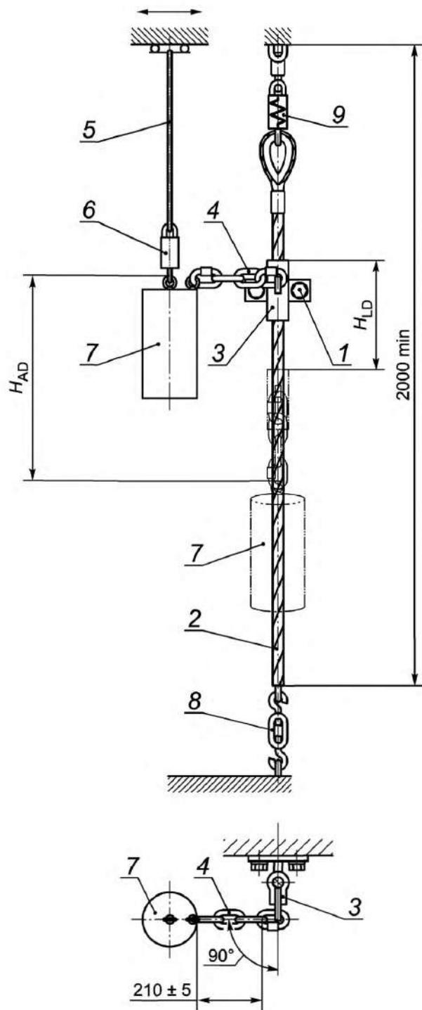
$H_{LD}$  — участок торможения;  $H_{AD}$  — страховочный участок; 1 — направляющий элемент;
