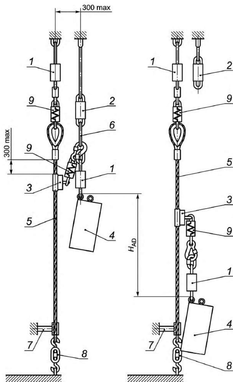
$H_{AD}$  — страховочный участок; 1 — тензодатчик; 2 — устройство быстрого расцепления;
