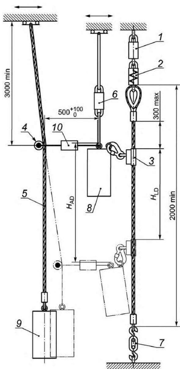
$H_{LD}$  — участок торможения;  $H_{AD}$  — страховочный участок; 1 — тензодатчик; 2 — амортизатор (при наличии);
