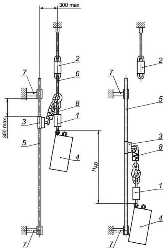
$H_{AD}$  — страховой участок; 1 — тензодатчик; 2 — устройство быстрого расцепления;
